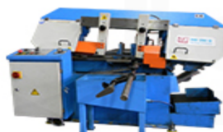
Нарезка калиброванного проката на заготовки
